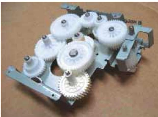
**Anwendung:** Getriebesatz eines Bürodruckers. Auswahl auf Grund der geringen Verschleißrate und Reibung gegen Metall, sich selbst und Standardtypen von DELRIN®.
