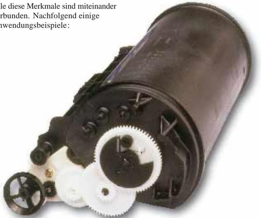
**Anwendung:** Zahnradatz aus DELRIN® 500AL für einen Bürodrucker. Auswahl auf Grund der Möglichkeit zum Betrieb ohne Schmierung, die Papier oder Toner verunreinigen könnte.
